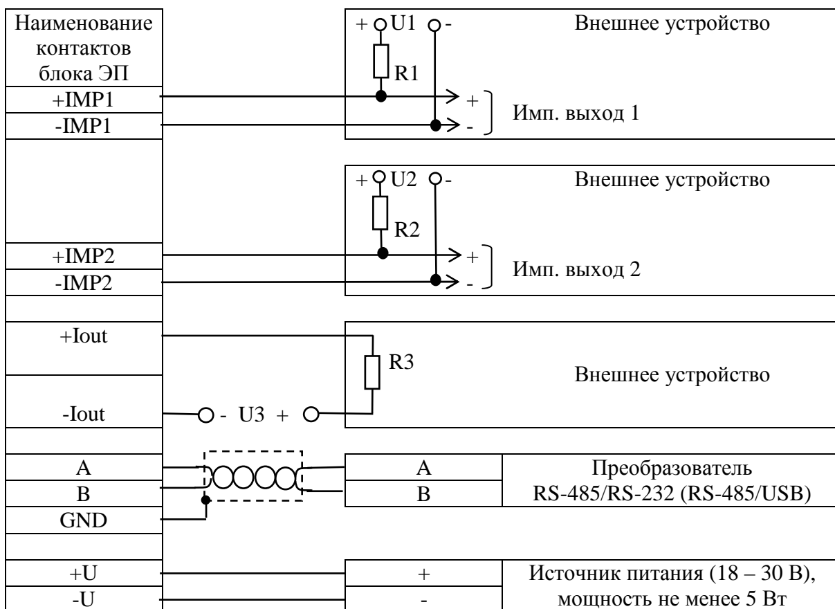
Схема подключения внешних устройств к блоку ЭП УЗС-1
